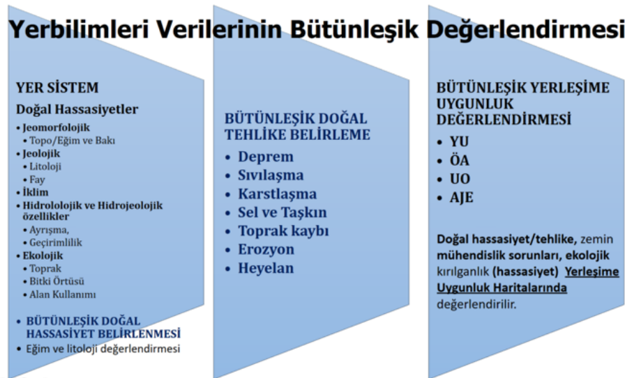
Şekil 1. Yer sistemini (jeolojik, iklim ve ekolojik) oluşturan süreçlerden kaynaklanan tehlike belirleme çalışmaları, jeolojik ve ekolojik hassasiyetlerin belirlenmesi ve bütünleşik yerleşime uygunluk (YU: yerleşime uygun, ÖA: önlem alınması gereken, UO: yerleşime uygun olmayan, AJE: ayrıntılı jeolojik etüd gerektiren alanlar) değerlendirmesi (Okay ve diğ. 2018).
