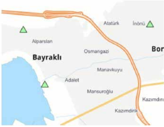
Şekil 13. Manavkuyu, Bayraklı civarında ölçüm alınan istasyonların konumları İstasyonların Vs30 değerleri sırasıyla 196, 836 ve 875 m/sn'dir. Bölgeye yakın istasyonlardaki veriler kullanılarak zemin yükseltgenmesi irdelenmiştir. Bu amaçla kayıtların ivme spektrumları Şekil 14'te karşılaştırılmıştır.
