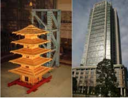
Şekil 5. Beş katlı pagodanın sönümlenme mekanizmasını anlamak üzere yapılan sarsma tablası deneyi ve bu yapı sistemini temel alarak inşa edilmiş Marunouchi binası [9]
