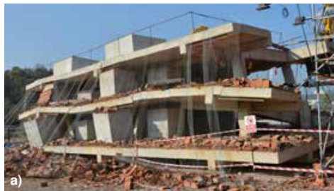
Şekil 4. Tam ölçekli bina deney sonu; a) Güçlendirilmemiş bina b) LP sargılama ile güçlendirilmiş bina [13,14]
